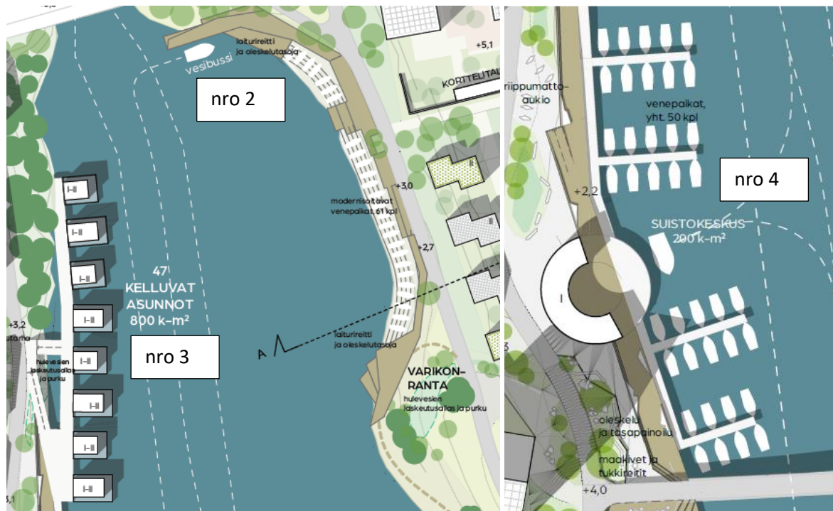
Kuva 15. Vaakunankylän kelluvien asuntojen ja Suistokeskuksen sekä Vaakunankylän veneenlaskupaikan rantoja joudutaan ruoppaamaan (Oulun kaupunki 2020a).
